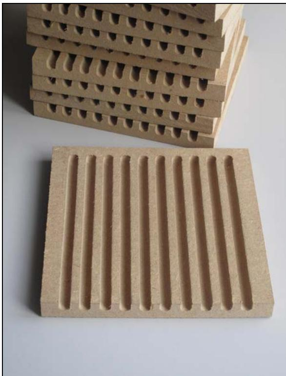
Abb. 67: Einzelbrett mit zehn Fräsungen
